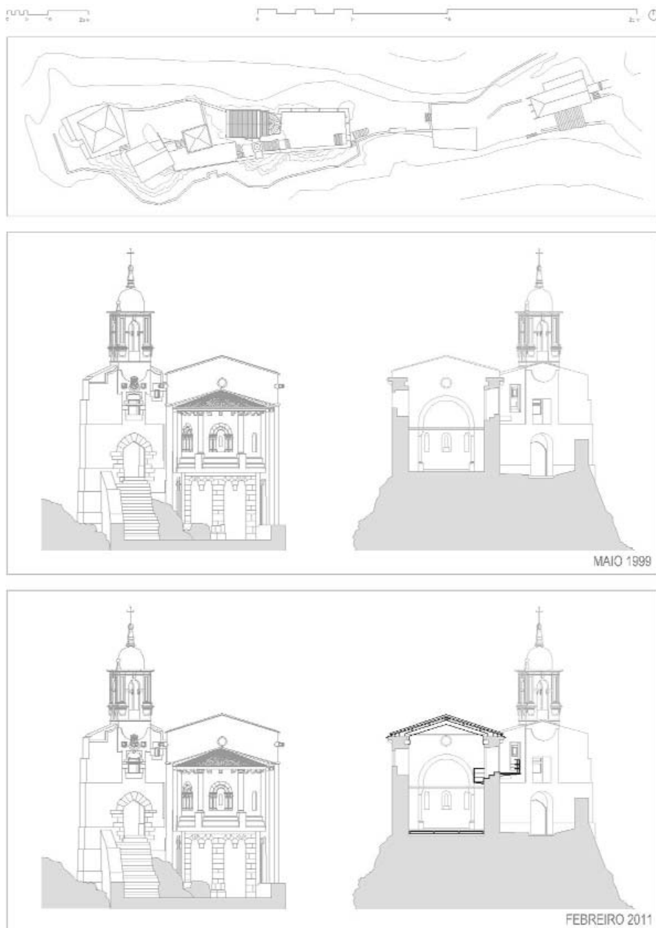
Fig. 09. CAAVEIRO. Alzado leste e sección transversal da Igrexa de Santa Isabel.
