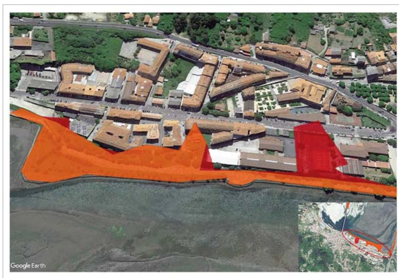
Fig. 7. Zonas inundables asociadas a la crecida del río debido a las precipitaciones recibidas. Períodos de retorno de 50 años (naranja) y 100 años (rojo). Zoom en la parte sureste de la villa. Fuente: Elaboración propia. Imagen de fondo de Google Earth
