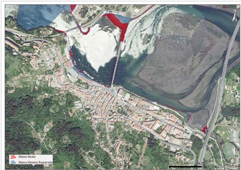
Fig. 4. Zonas inundables asociadas a la marea media y a la marea máxima registrada en Pontedeume. Fuente: Elaboración propia. PNOA cedido por Instituto Geográfico Nacional (IGN)
